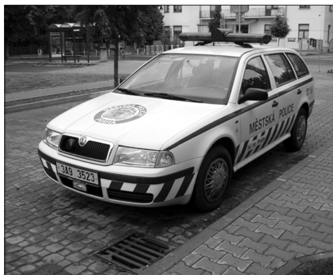
Vozidlo s radarem. Na přední masce je čidlo radaru a pod SPZ blesk fotoaparátu.
