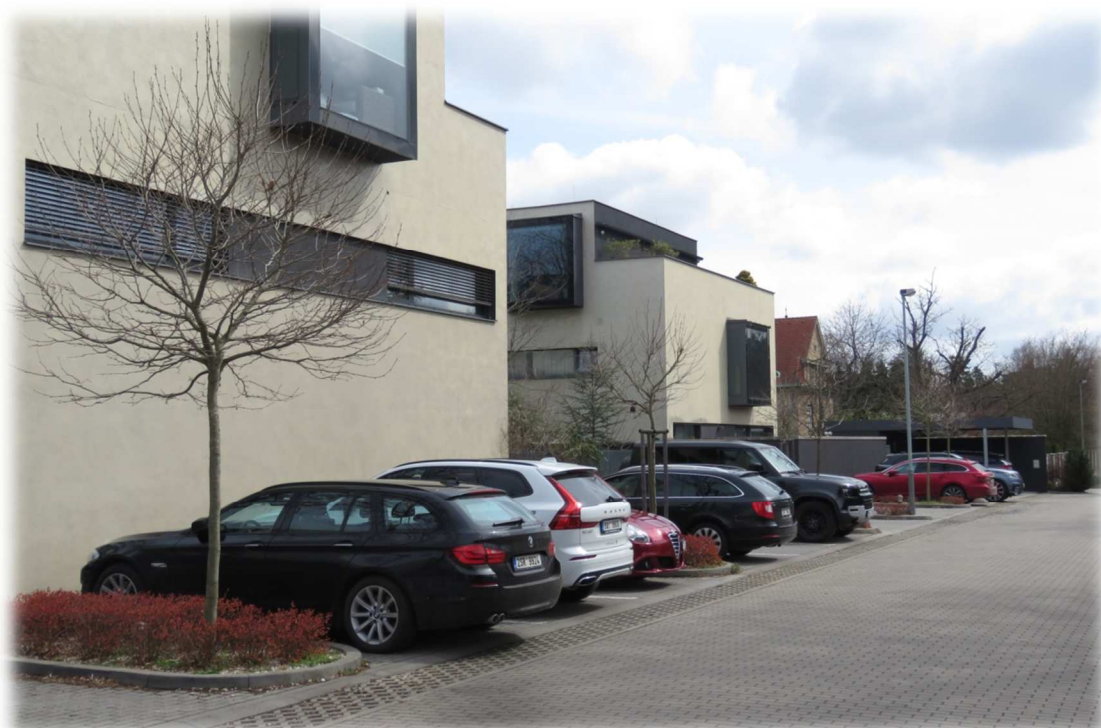
Obrázek 48: Problémem by se mohlo zdát parkování. Typicky nezvládnuté soužití stromů a aut, kde je všechno naruby. Obrubníky jako bariéry proti rozvoji stromů. Zdánlivý však vůbec neslouží stromům, slouží-li něčemu. Nепropustné dlažby a hrany zbytečně omezují kapacitní parkování i stromy samotné.
